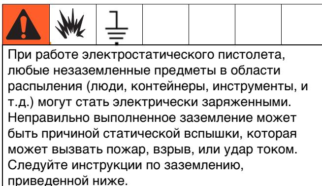
Следующее - это минимальные требования к заземлению для основной электростатической системы. Ваша система может также включать иное оборудование и предметы, требующие заземления. Для получения подробной информации по заземлению см. местные электротехнические правила и нормы. Система должна быть подсоединенна к надежной линии заземления.
